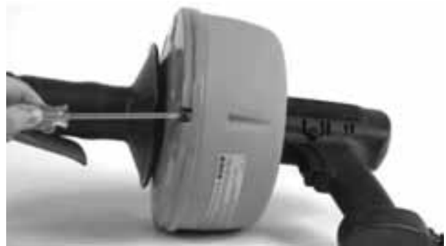
Figur 6 – Løsne fire (4) skruer fra bakre halvdel av trommelen omkring tre (3) fulle omdreininger
