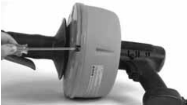
6. ábra – Lazítsuk meg a tartály hátsó felének négy (4) csavarját kb. három (3) teljes fordulatnyit
