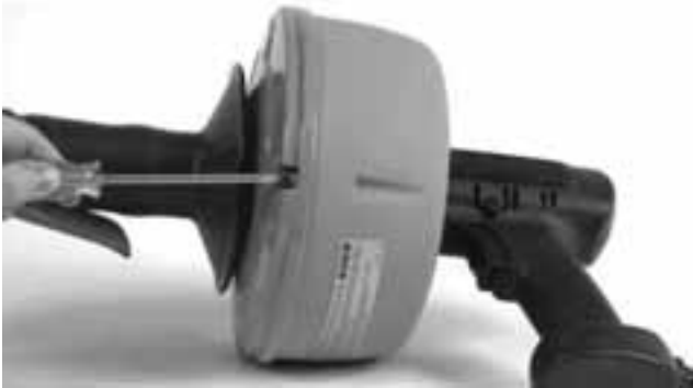
Abbildung 6 – Lösen Sie vier (4) Schrauben in der hinteren Magazinhälfte etwa drei (3) ganze Umdrehungen
