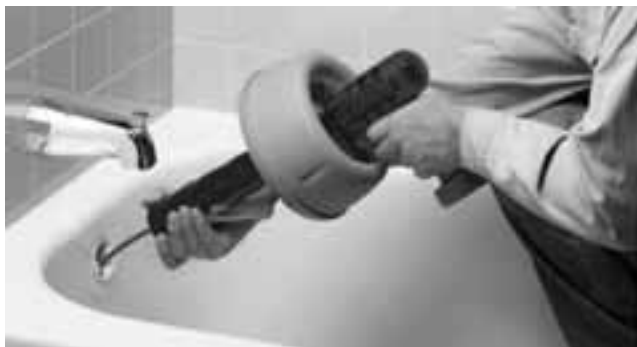
Figura 5 – Deje una distancia entre la apertura de la tubería de drenaje y el morro de la herramienta de 15 cm como máximo.
