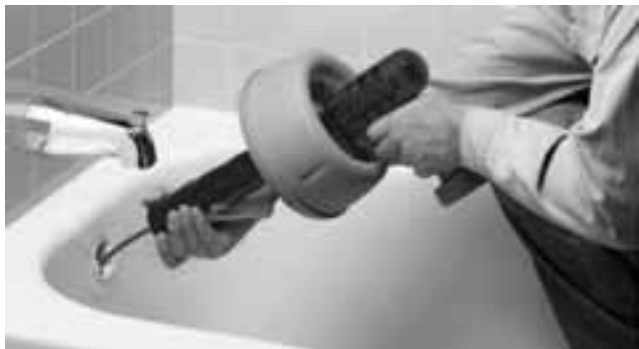
Rysunek 5 – Utrzymywać odległość pomiędzy otworem ściekowym i końcówką maszyny równą 6 cali lub mniej
