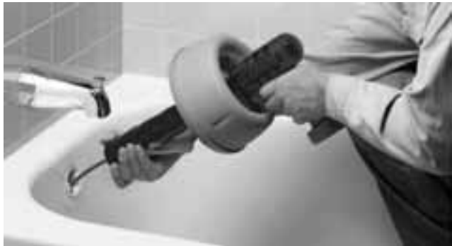
Figur 5 – Hold avstanden mellom drensåpningen og drenspistolens tupp på 6 tommer eller mindre
