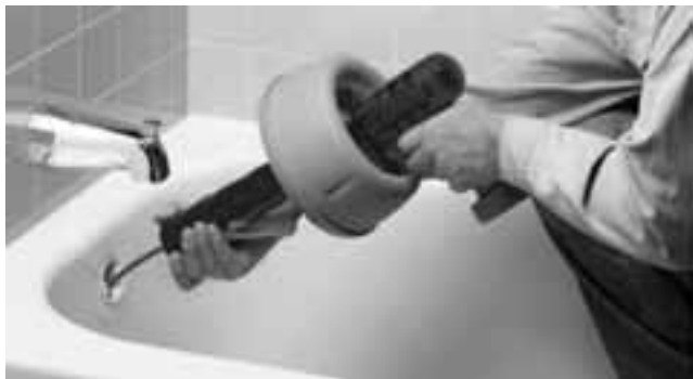
Figura 5 – Mantenere la distanza fra l'apertura della tubazione e il naso della pistola di sturatura a 15 cm o meno
