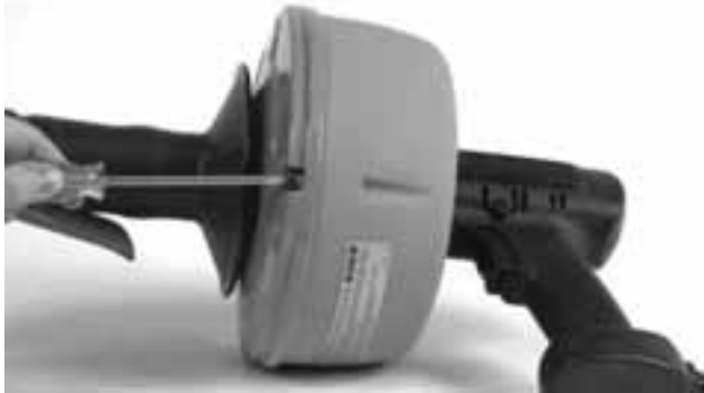
Εικόνα 6 – Ασκήστε τις τέσσερις (4) βίδες στο πίσω τμήμα του κελύφους κατά τρεις (3) πλήρεις στροφές
