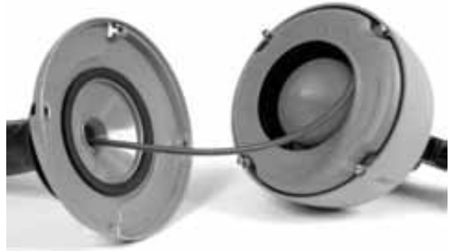
7B. ábra – A kihúzott kábelt vezessük keresztül az első féldarabon, majd az első féldarabot szereljük vissza a tartály hátsó féldarabjára.
