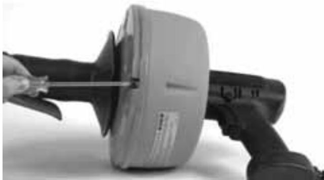
Figur 6 – Lossa fyra (4) skruvar från bakre sidan av behållaren cirka tre (3) hela varv
