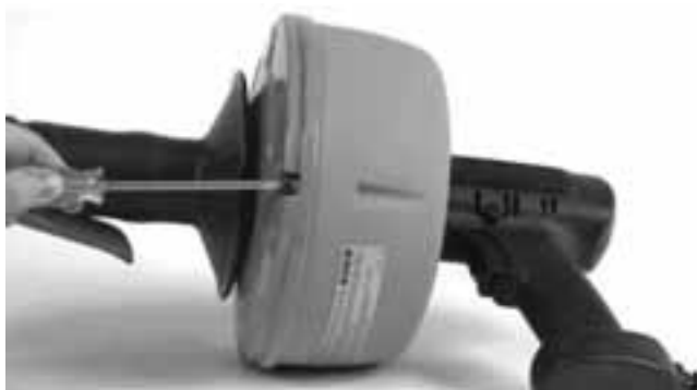
Figura 6 – Afloje los cuatro (4) tornillos de la mitad trasera del compartimento aproximadamente tres (3) vueltas completas.
