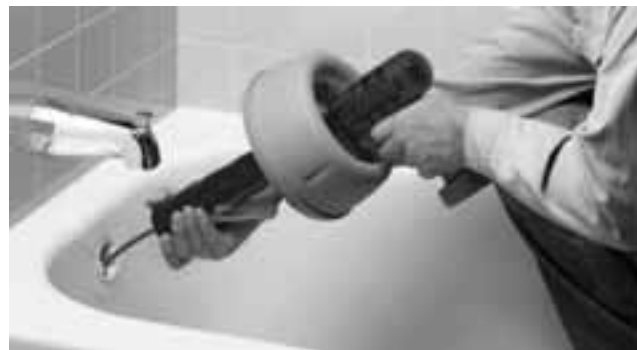
Figuur 5 – Houd afstand tussen afvoeropening en neus van ontstoppingsmachine tot 15 cm of minder
