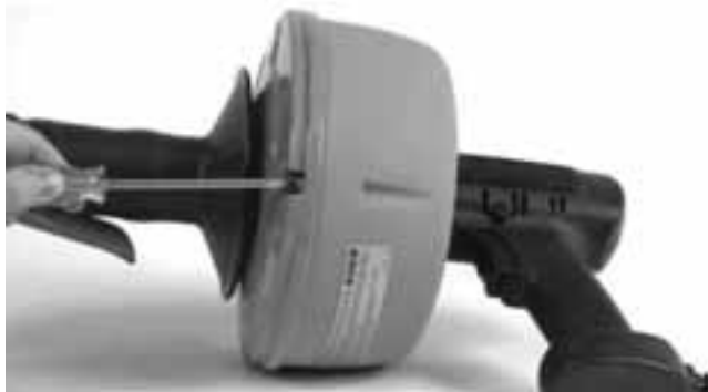
Figure 6 – Desserrez quatre (4) vis de la moitié arrière de la cartouche de trois (3) tours complets
