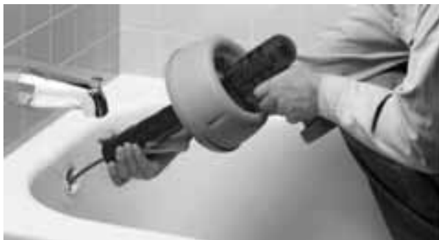
Figur 5 – Håll ett avstånd mellan avloppsöppningen och främre spetsen till högst 15 cm
