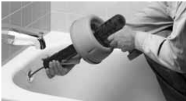
Figura 5 – Mențineți distanța dintre deschiderea canalului și ciocul aparatului de desfundare la 15 cm sau mai puțin
