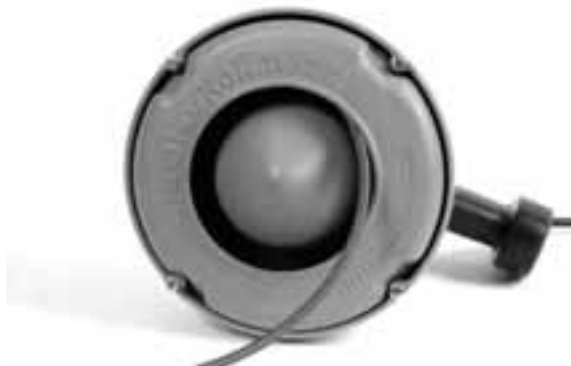
Slika 7A – Kada umećete sajlu u unutrašnji bubanj, motajte sajlu u smjeru kazaljke na satu
