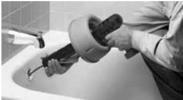
Рис. 5 – Выдерживать между отверстием канализации и выходным отверстием машины 15 см длины спирали или менее
