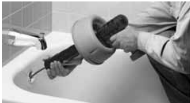
Figure 5 – Maintenez une distance égale ou inférieure à 6" entre l'ouverture de la canalisation et le nez de l'outil
