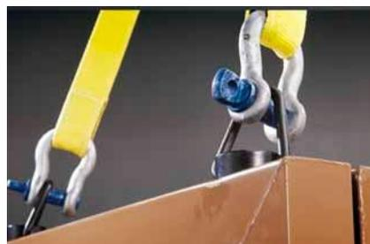
Четырёхточечная крановая подъёмная система с использованием среднеточечного такелажа способствует более безопасному подъёму по сравнению с двухточечной/брусовой подъёмной системой и обеспечивает грузоподъёмность при общей массе 1.100 кг.
