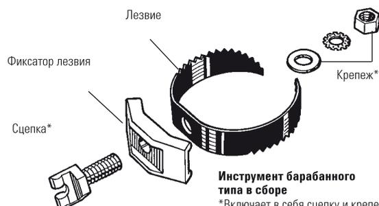
**Инструмент барабанного типа в сборе**
